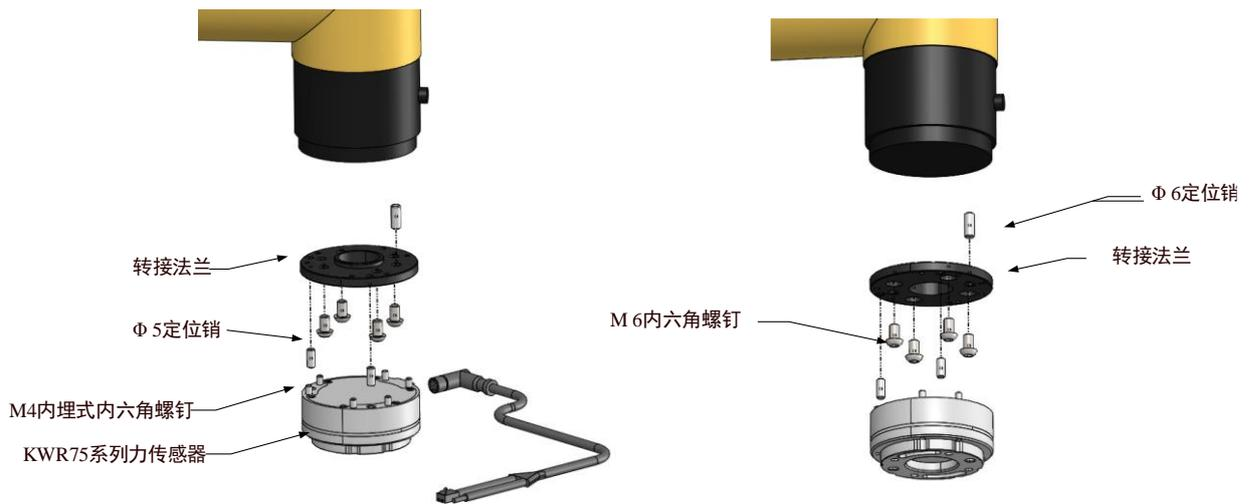
图 5 传感器与设备连接安装示意图
